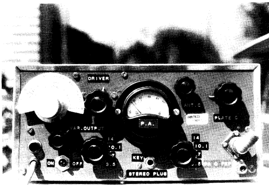
Dit is de zender, gefotografeerd aan de voorzijde. Links de atstemknop met ingebouwde vertraging. In 't midden de weekijzermeter. De beide zwarte knoppen links en rechts van de 'stereo plug' moeten steeds op eenzelfde band geschakeld staan. Zie verder de tekening fig. 3.
